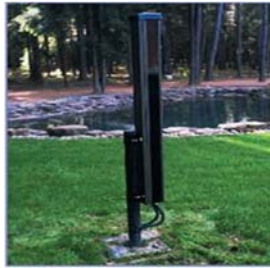
Şəkil 1.5. Çoxşüalı İQ duyğalarının tətbiqi: a) divarda, b) ərazidə
