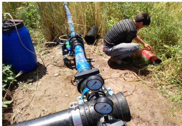
Рисунок 6. Промывка дискового фильтра
